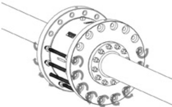
Abbildung 6 – Drehen Sie alle Zugbolzenmuttern gegen den Uhrzeigersinn
