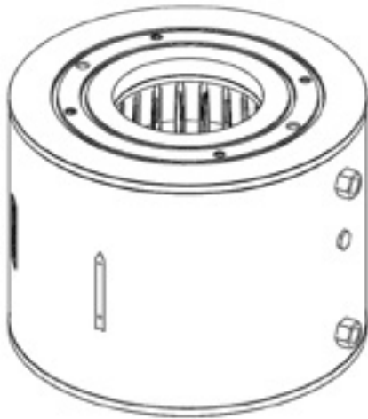
Abbildung 11 – Bringen Sie die Rumpfbaugruppe mit der Eintrittsseite nach unten an
