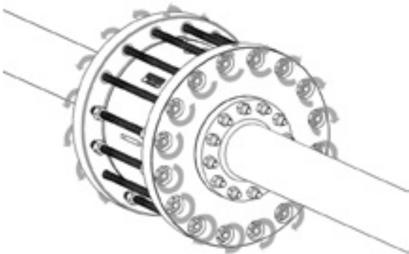
Abbildung 24 – Ziehen Sie die Zugmutter mit dem entsprechenden Drehmoment an.
