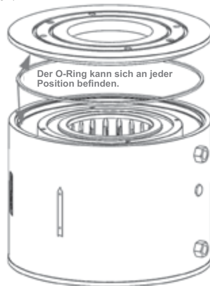
Abbildung 13 – Entfernen Sie den O-Ring von der Austritts-Rumpfhülse.
