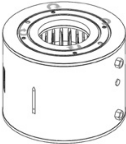
Abbildung 19 – Wenden Sie auf die Kopfschrauben der Abdeckplatte das richtige Drehmoment an.
