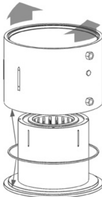
Abbildung 14 – Entfernen Sie den O-Ring der Rumpfhülse und der Eintritts-Rumpfhülse.
