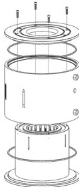
Abbildung 18 – Bauen Sie die Rumpfbaugruppe wieder zusammen.
